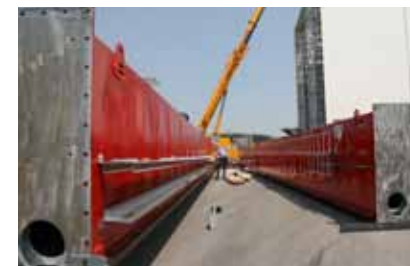
Die fachgerechte Installation der RGBs (Regalbediengeräte)
